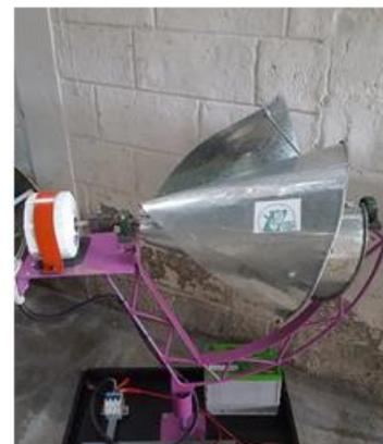
Turbina Eólica Espiral de Arquímedes.
