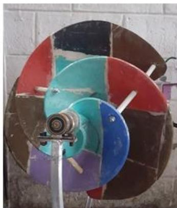
Turbina Eólica Espiral de Arquímedes.
